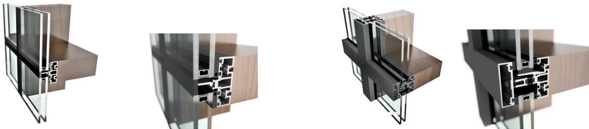
L'option pour revêtement de façade ThermaWall 2600 convient aux vitrages de vision de ¼" (6 mm), 1" (25,4 mm), 1 ⅛" (28,6mm), 1 ¼" (31,8 mm) et 1 ¾" (44,4 mm) ainsi qu'aux tympan. Il présente une ossature à profil bas (2 ½"/62,7 mm de large x 0,75"/19,1 mm de profondeur) qui peut être fixée directement à un substrat structurel existant, tel que des panneaux muraux en béton, de la maçonnerie, une ossature en bois ou en acier.
